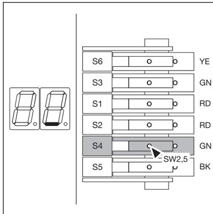
6-14.3 Индикация конечного положения закрытых ворот, зафиксируйте кулачок
