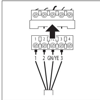
4-2.2 Подсоединение кабеля двигателя к гнездовому контактному зажиму
