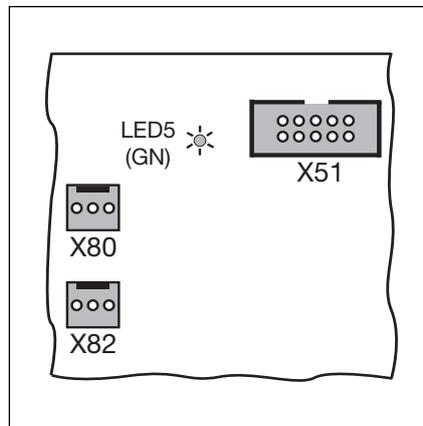
7-4.2 X51 = гнездо для подключения к системе управления, LED5 = Светодиод рабочего напряжения, X80/X82 = гнездо для подключения дополнительных плат.
