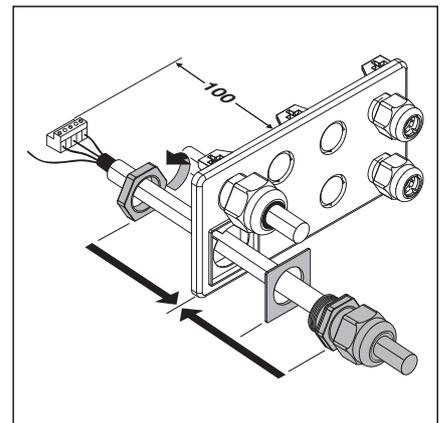
4-2.6 Окончательный монтаж на крышке корпуса системы управления
