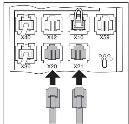
4-4.3 Подключение устройств защиты с помощью системного провода
