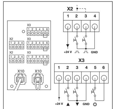
4-4.2 Подключение дополнительных внешних элементов управления к X10
